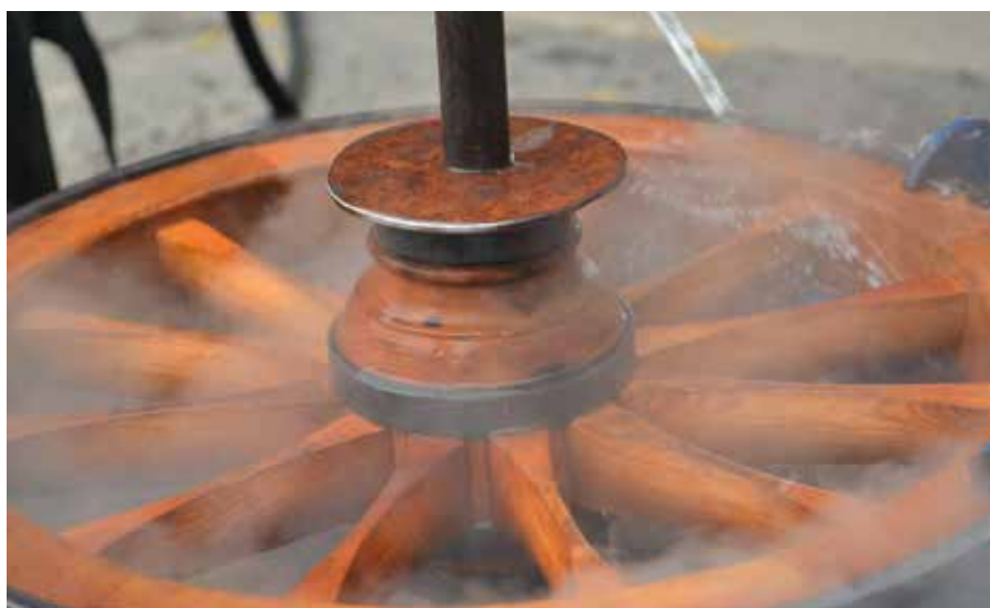
Une fois en place, le tout est refroidi afin que le bois ne soit pas endommagé par le feu. / Nach dem Aufstellen wird alles abgekühlt, damit das Holz nicht durch das Feuer beschädigt wird.
